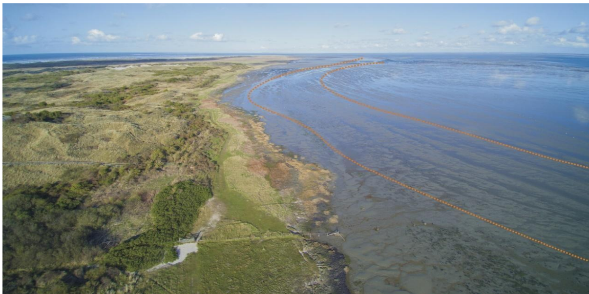
Figuur 18. Beeld van het wad ten zuiden van het Oerd en de Hon tijdens laagwater waarop het stroomgebied vanaf het Pinkegat over de wadplaat naar de Oerdblinkert (linksmidden op de foto nog net zichtbaar) en Oerdsloot (achter camerastandpunt) ingetekend is. Binnen de arcering bevindt zich het gebied waar een netto verlaging heeft plaatsgevonden.
