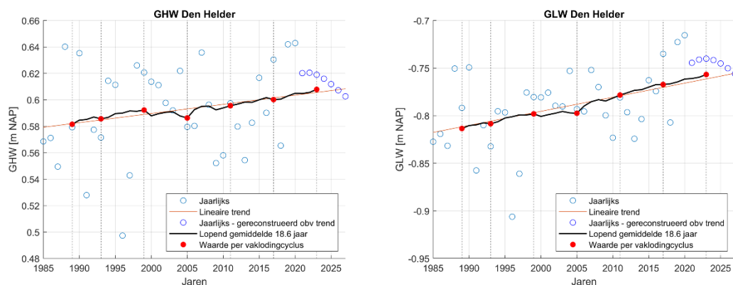
Figuur 3.1 Bepaling van representatieve GHW en GLW waarden per vaklodingscyclus in 3 stappen; voorbeeld Den Helder. Deze stappen worden uitgevoerd voor alle waterstandsstations langs de Waddenzee.
