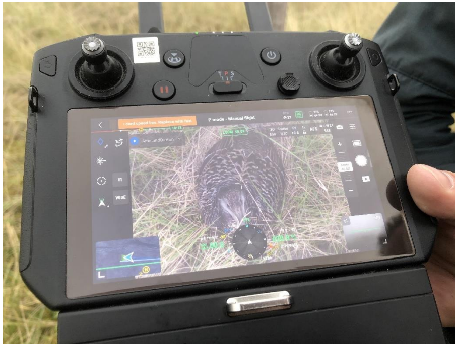
Foto 3. Opname van het besturingsscherm van de drone die in dit geval broedende vrouwtjes Eider zoekt. Deze worden in zo koud mogelijke omstandigheden (ochtend of avond) met een warmtebeeldcamera gezocht. Een daglichtcamera met sterke zoomlens laat vervolgens zien of het witte stipje op het wamtebeeld een Eider betreft of niet. Na het uitkomen van de eieren worden de met de drone verkregen coördinaten bezocht met een RTK/DGPS apparaat voor een exacte XYZ meting in de nestkom. Foto: Johan Krol, 8 mei 2023.
