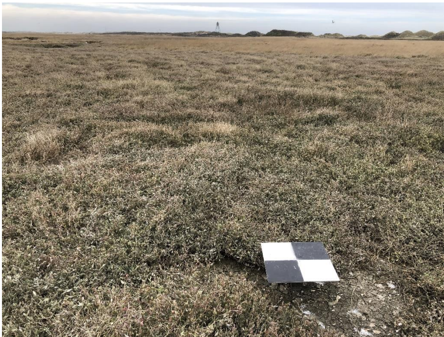
Foto 4. Tijdens het vliegen met een drone liggen in het terrein zwart-wit tegels waarvan de exacte positie met RTK/DGPS apparaat is ingemeten. Hiermee kunnen de opnames die met de drone worden verkregen op de juiste positie worden gerefereerd. Op de Hon gaat het om 15 zw-tegels, waarvan 12 op vaste posities (zie foto) die voor het broedseizoen worden geplaatst en in het najaar weer worden weggehaald. Op het Neerlands Reid gaat het om 7 referentietegels.
