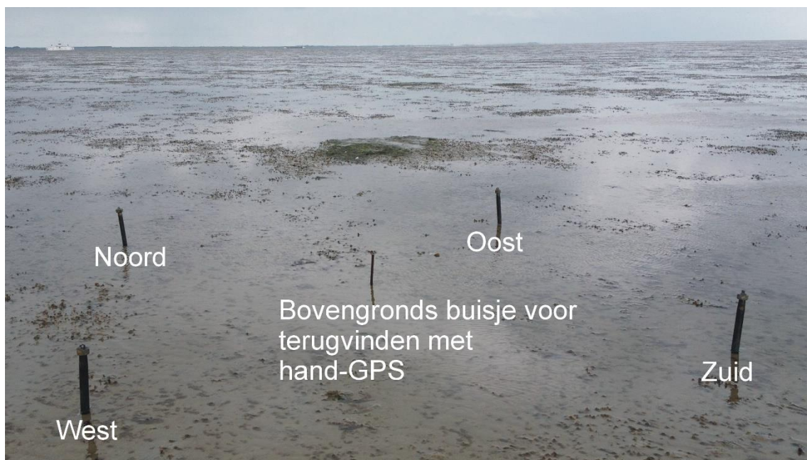
Figuur 3. De 4 grondankers die ongeveer 80-100 cm onder het oppervlak worden geschroefd. Hieraan is een dyneema lijn met aan het bovengrondse deel een identificatieblikje en aluminium afleesring bevestigd (figuur 6).
