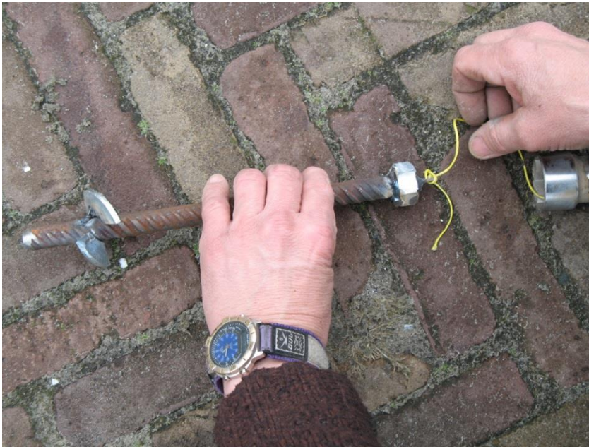
Figuur 2. Eigenbouw grondanker waaraan niet rekkend meettouw bevestigd wordt. Rechts de dop aan het uiteinde van de T-grondboor waarmee het anker in de bodem geschroefd wordt (figuur 3).
