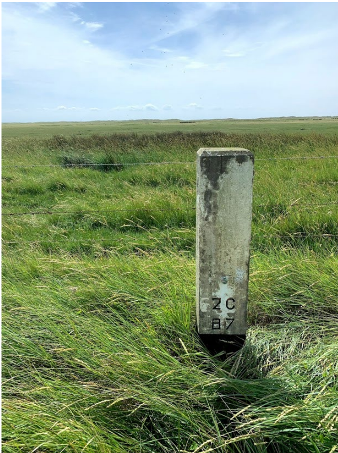
Figuur 2. Peilmerk 02C87 (RD-coördinaten: 187027.38; 608369.95) aan de noordkant van Neerlands Reid, naast het fietspad dat iedere meetdag werd gebruikt om de meetnauwkeurigheid te bepalen (Foto Loek Kuiters).
