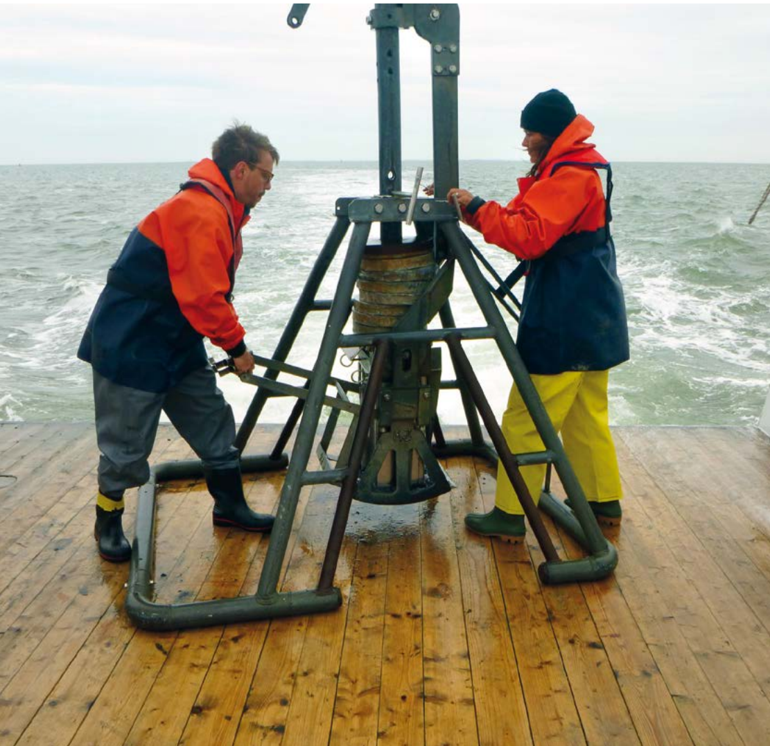
Voorbeeld van een box corer, een instrument waarmee wadbodem wordt verzameld. Foto: Sander Holthuijsen
