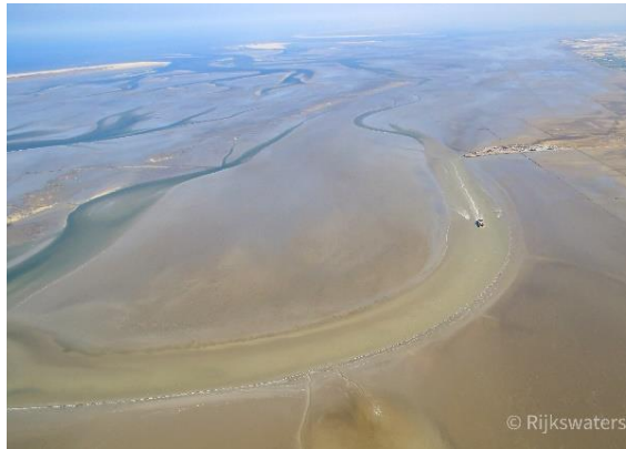
Hoge vertroebeling in de Vaargeul bij Holwerd en helderder water in naastgelegen geulen. Rechtsboven de veerdam en de landaanwinningswerken.
