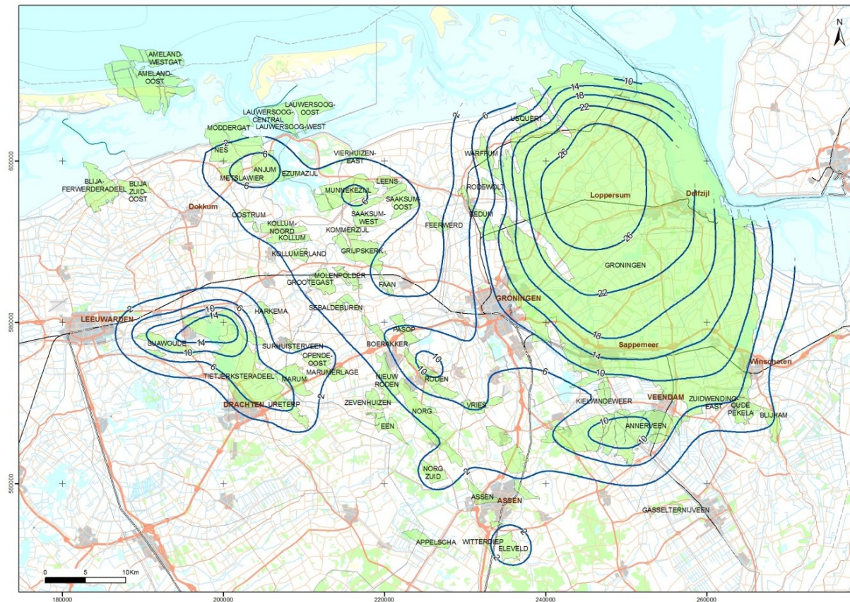
Figuur 3.4 Contourkaart voor de bodemdaling door gaswinning vanaf het begin van de winning in 1964 tot de waterpassing van 2008 (NAM 2010).
